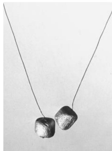
1.1.1 Разноимените полнежи се привлекуваат. Две спротивно наелектризирани лесни топчиња од стиропор, закачени на конец.
