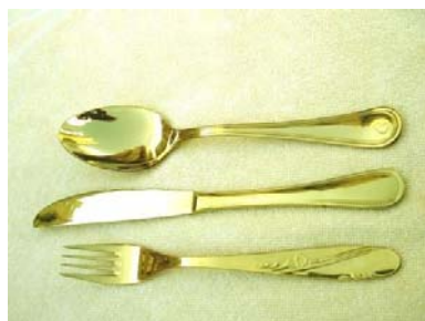
Тенок слој од титан оксинитрид нанесен со катодно распршување во фирмата Плазма од Скопје
